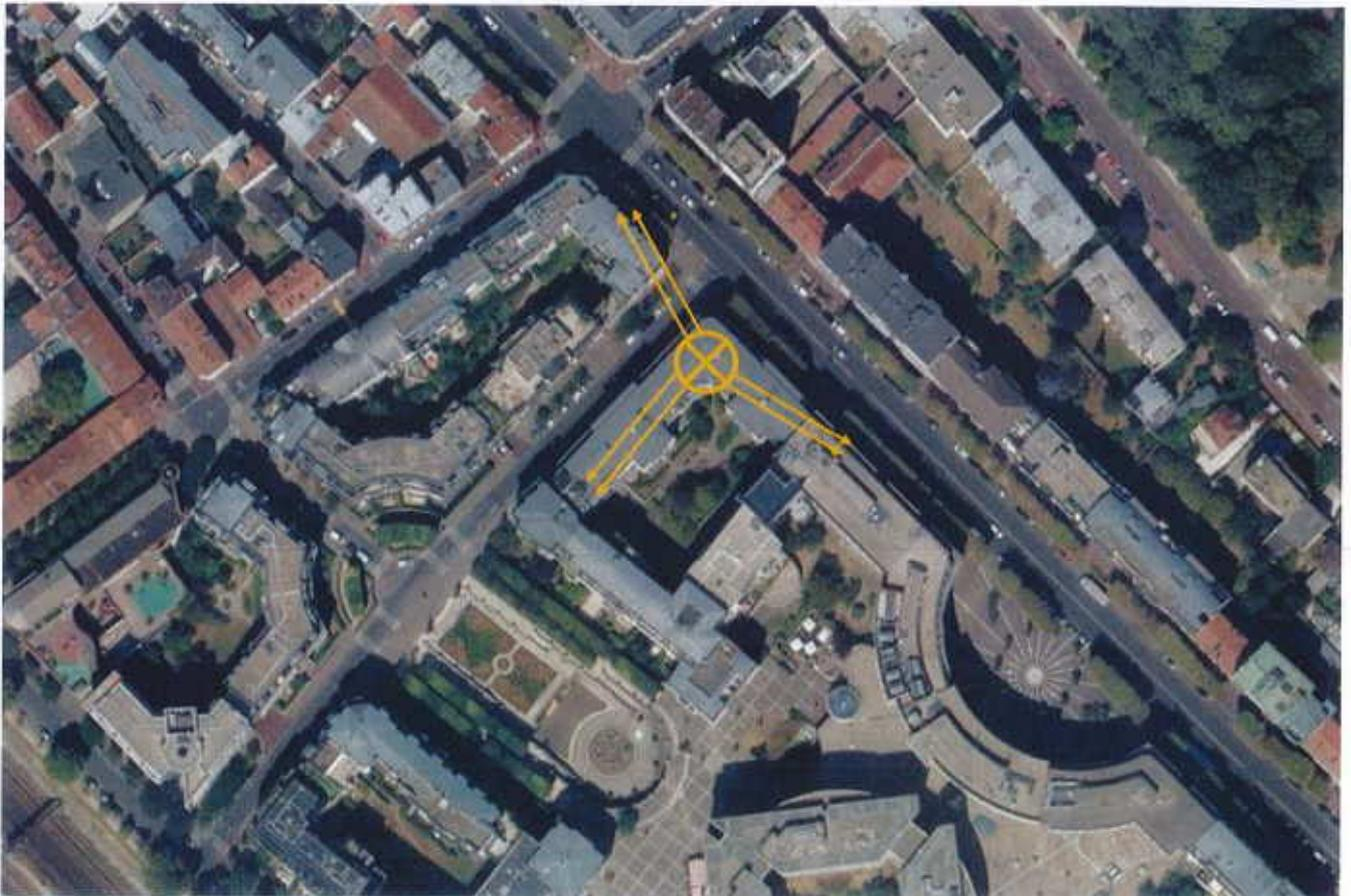
Il n'y a pas d'ouvrant dans un rayon de 10m de l'antenne.
